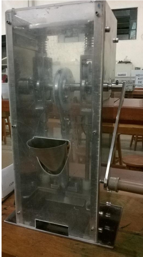
Figura 7 - MCC na bancada do Laboratório de Engenharias e Arquitetura do Unisalesiano Araçatuba, com as proteções em acrílico instaladas. Fonte própria.
